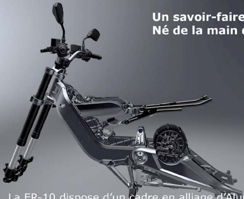
La ER-10 dispose d'un cadre en alliage d'Aluminium forgé. Façonné avec une alternance de parties creuses et pleines pour plus de légèreté et une finition parfaite.
