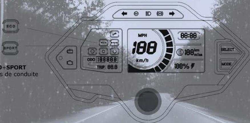
La ER10 dispose d'un système de détection de lumière intelligent permettant d'ajuster automatiquement la luminosité du rétroéclairage en fonction des changements de la lumière environnante.
